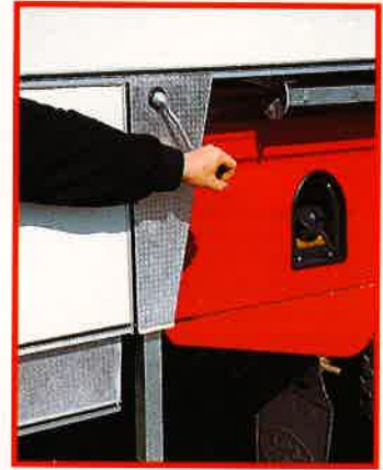
Für sicheren Stand und zum Abnehmen der Hütte: Per Handkurbel werden die Stützen ausgefahren.
