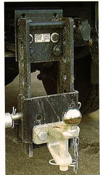
Perfekt: Verstellbare Dixon-Bates-Kupplung mit Zugmaul.
