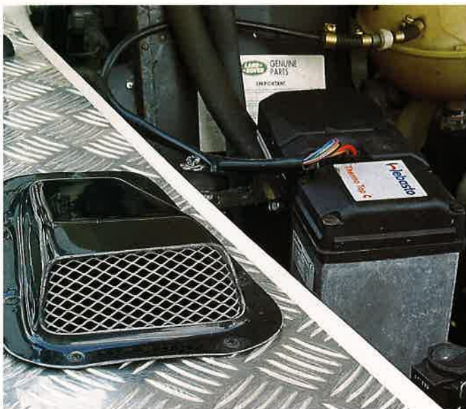
Nachgerüstet: Die Webasto-Standheizung atmet durch einen abgedeckten Lufteinlass und erwärmt den Innenraum sehr schnell.
