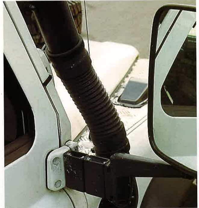
Aufgesetzt: Voller Rückblick dank Spiegelarm-Verlängerung.
